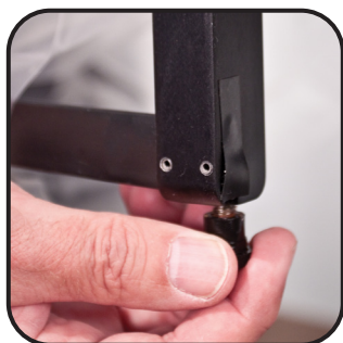
2. Umocować końcówki obręczy do końców szyn teowych stołu. Dokręcić pokrętła zaciskowe końców obręczy do szyny teowej.
